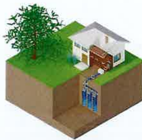
Pompe à chaleur sur corbeilles géothermiques
