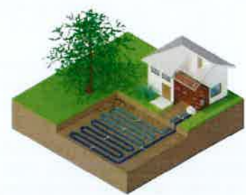
Pompe à chaleur sur capteurs enterrés horizontaux
