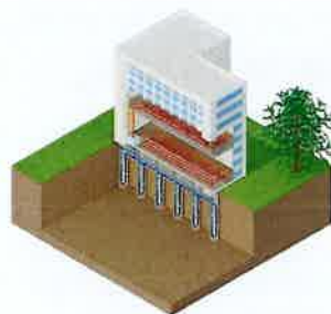
Pompe à chaleur sur géostructures énergétiques
